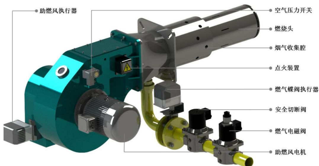
图 6.2-1 燃烧器结构图
